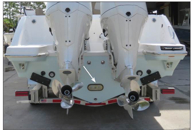
Transom Sacrificial Anode
